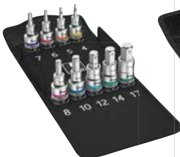
● 1/2", 9-teilig, für Innen-Sechskant, mit Haltefunktion • SW 4/5/6/7/8/10/12/14/17, 60 mm
